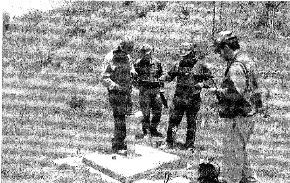
Muestreo de agua en piezómetros por laboratorio acreditado por EMA y autorizado por CNA
