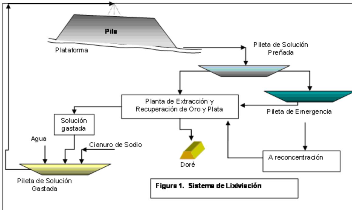
**Figura 1. Sistema de Lixiviación**
